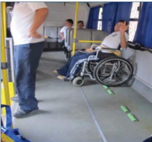
Imagen: La persona usuaria de silla de ruedas orientada de manera perpendicular al desplazamiento del vehículo, no es adecuada para la seguridad del ocupante en caso de choque.
