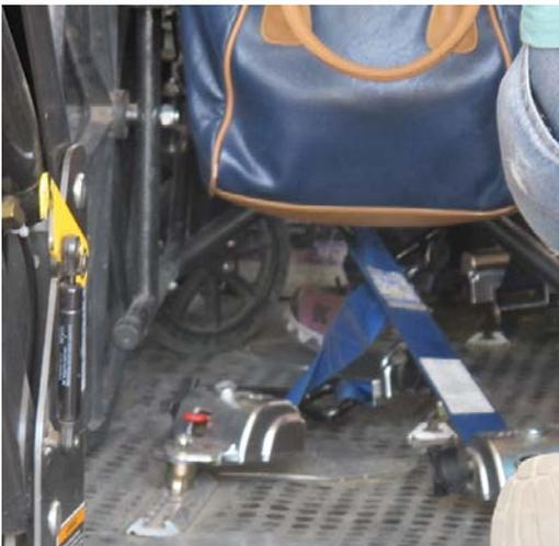
Izquierda: Colocación inadecuada de cinturones para sujeción de silla de ruedas.
